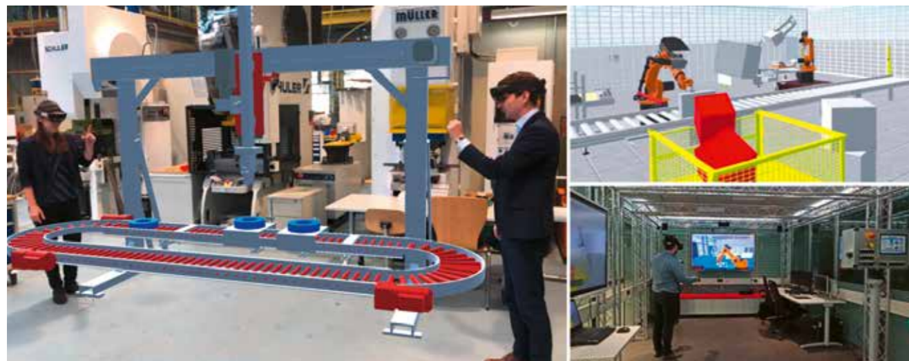
Abb. 1: Mixed-Reality-in-the-Loop Simulation einer Pick&Place Station mit Augmented Reality (links) und einer Roboter-Band-Applikation mit Physik-Engine in Virtual Reality (rechts oben) sowie das Future Control Center (rechts unten). (Quelle: VAL)
