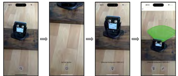
Abb. 4: Anwendungsfall 2 (Von links nach rechts: (1) Ein Sensor existiert (2) Beim Drücken auf den Suche-Button beginnt die Suche nach einem Sensor (3) Der Sensor wird erkannt (4) Die Wirkbereiche werden in AR dargestellt) [3]
