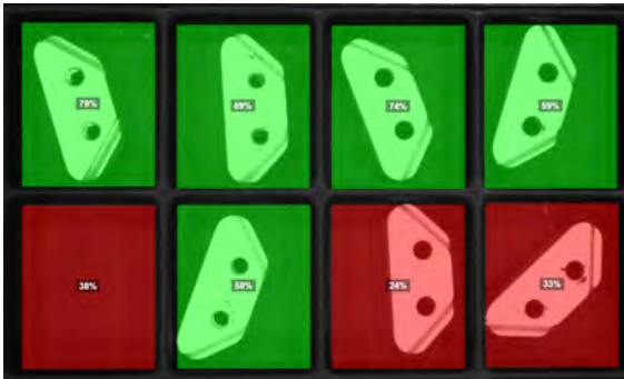
Abb. 2: Beispiel einer Anwesenheitskontrolle von beweglichen Objekten im Werkstückträger [1]
