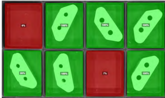
Abb. 3: Beispielergebnis einer Anwesenheitskontrolle mit Lagenachführung [1]
