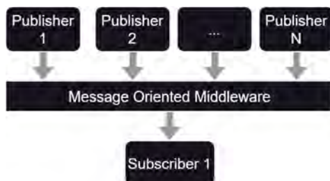
Abb. 1: Schematische Darstellung der PubSub-Kommunikation über die MOM [2]
