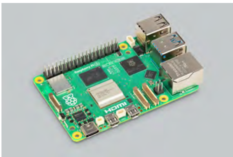
Abb. 2: Der Raspberry Pi 5 - Modell mit grundlegenden Komponenten und Anschlüssen [2]
