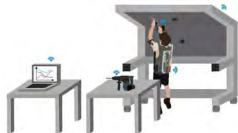
Abb. 1: Simulator zur Evaluation von Bohrungen mit Exoskelett. Die Werkzeuge und der Simulator senden Daten über MQTT an den Laptop. Auf dem Laptop speichert das Datenerfassungs-Framework die Daten. [4]
