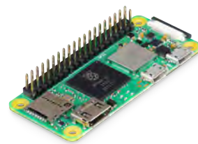
Abb. 3: Der Raspberry Pi Zero 2 WH - Kompakte Version mit ARM Cortex-A53 Prozessor [3]
