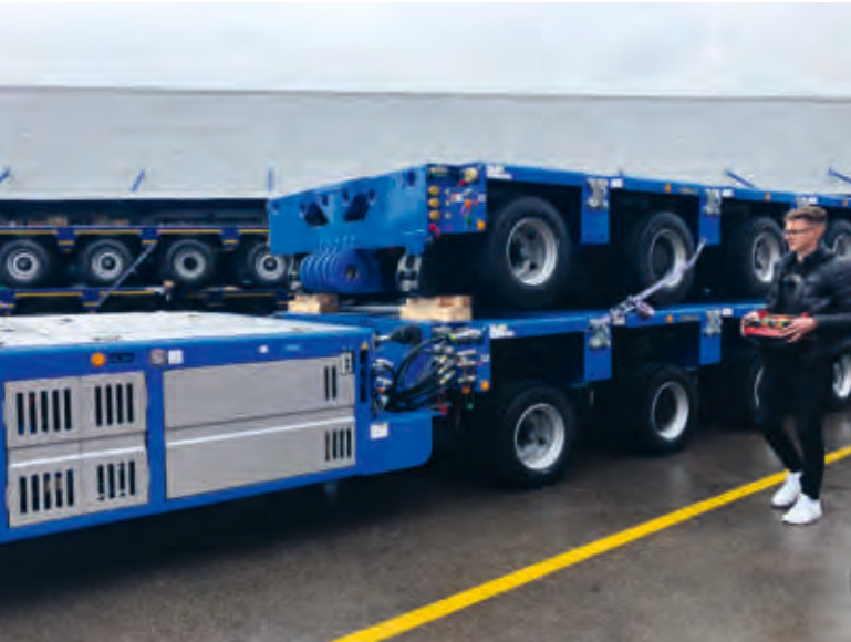
Abb. 1: Steuerung des ADDrive der Firma Goldhofer durch einen Studenten. (Quelle: Alexandra Steck, Anton Wittor)
