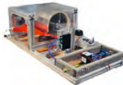
Abb. 1: Proof of Concept eines Latentwärmespeichers mit konstanter Entladeleistung im Rahmen eines Interdisziplinären Projekts im Studiengang WNB. (Quelle: Hochschule Esslingen)
